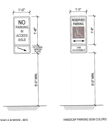
LEGEND & BORDER - RED BACKGROUND - WHITE LEGEND & BORDER - GREEN WHITE SYMBOL ON BLUE BACKGROUND NOTE: APPROPRIATE ARROW PLATE MAY BACKGROUND - WHITE BE USED WHEN IT IS NECESSARY 1 SIGN PER PARKING SPACE TO OFFSET INSTALLATION LOCATION DUE TO ACCESS RAMP
